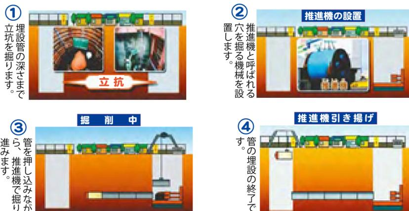
推進工法（左記参照）は、道路を全線にわたって開削しないため、騒音や振動などの建設公害が少なく、歩行者や車両の通行止めの期間も最小限に抑えられ、周辺への影響の少ない工法です。また、既成管を使用するため施工後直ちに使用することができ、工期短縮が図られ、工事に掛かる費用は他の工法に比べ割安となる見込みです。それでも、平成27年度～29年度の3年での事業費は約11億4,800万円（国庫補助・東京都補助金を含む）で、時間も膨大にかかる事業となっています。
