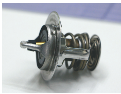
自動車用サーモスタット。小さな部品だが、エンジンを高温から守る大切な役割を果たす
