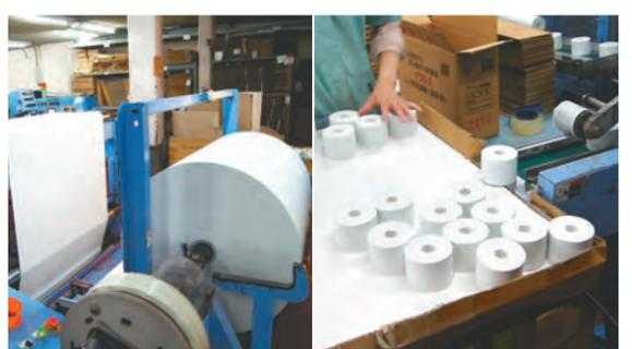
(写真左) 幅1メートルを超える巨大なロール紙から、(写真右) のレジロールが造られる
