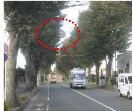
枝葉が標識や信号を遮る危険がある。 なお、速度制限の左に駐車禁止の標識もあるが、枝で見えていない。
